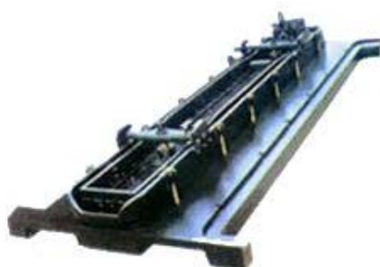
图2 挂釉焦炉炉门
