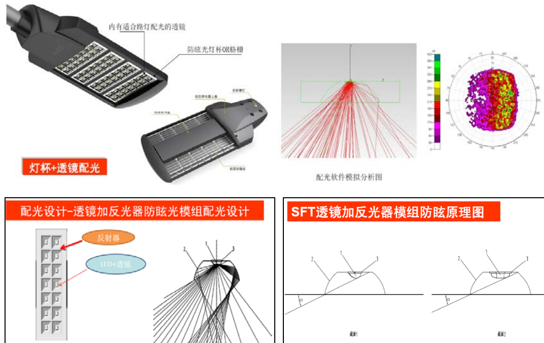
图 2 采用自由曲面透镜加反光系统的配光系统示意图
